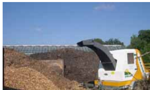
Broyage des déchets de taille
