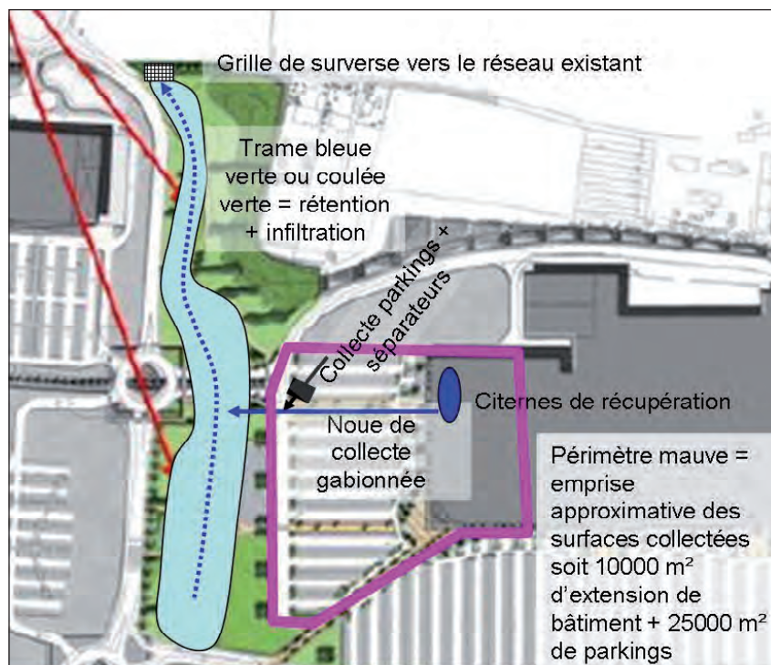
Cheminement de l'eau et surfaces collectées sur la partie restructurée
