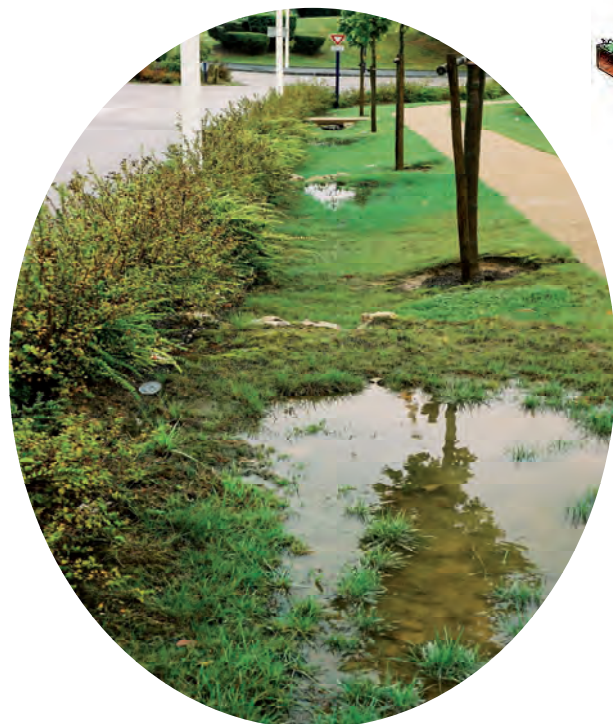
Noue engazonnée avec arbres d'alignement à grand développement
