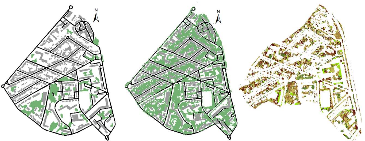
Figure 2 : Apport de la télédétection haute résolution pour l'identification de la végétation. L'augmentation de la résolution spatiale permet de distinguer des espaces verts de plus en plus petits (au milieu). L'augmentation de la résolution spectrale permet de distinguer le type de végétation, ici : surface herbacée, 3 types de conifères et 5 types de feuillus (à droite). Source : LPGN, ONERA.
