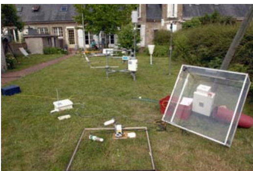
Photos n°8 (en haut) : Façade végétale implantée sur le banc expérimental ClimaBat et instrumentée. Photo n°9 : Jardin instrumenté (en premier plan la cloche de mesure d'évapotranspiration). Photo n°10 : Instrumentation sonore d'une façade végétale sur un bâtiment. Photo n°11 : Mesures des caractéristiques optiques de la toiture végétalisée du banc expérimental ClimaBat.
