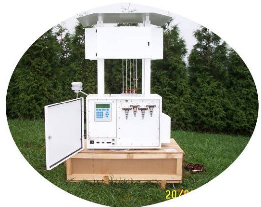
Figure II-4 : Mise en place des supports de prélèvements sur le préleveur (Source : Atmo-Nord Pas de Calais)
