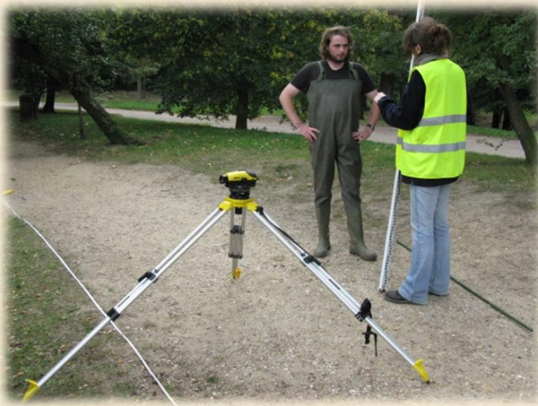
Fig. métré au théodolite
