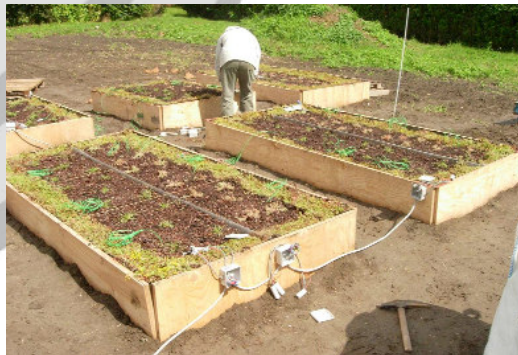
Cablage pour saisie automatique de données d'expériences de toitures végétalisées
